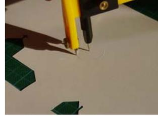
Mit dem Schneidmesser, der Matte und dem Kreisschneider werden Schablonen angefertigt...
